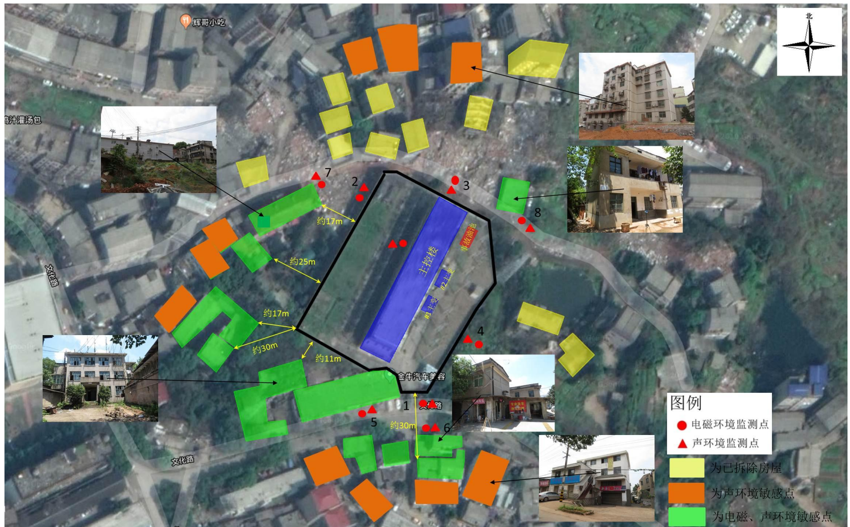
附图 3：湖南株洲月形山 110kV 变电站与周围环境保护目标位置关系及电磁、声环境现状监测布点图
