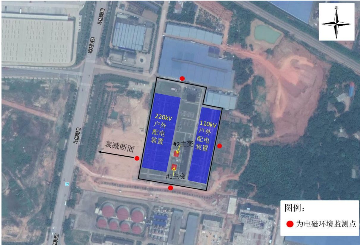
图 8 楠竹塘 220kV 变电站平面布置及监测点位示意图
